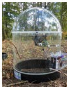
Rund 60 cm hoch und ein Durchmesser von 50 cm. Ein Dichtungsring verhindert den Gasaustausch mit der Atmosphäre.
